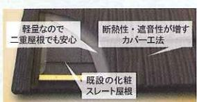
屋根材が雨音を吸引・拡散するため遮音性を確保。さらに鋼板とストーンチップの複合効果により放熱し、空気層が断熱効果をもたらします。
