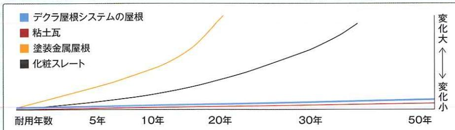
天然石ストーンチップとガルバリウム鋼板使用。独自の8層構造の溶融亜鉛鋼板で、亜鉛メッキ鋼板の3~6倍の耐久性を持ちます。他の屋根材と比較しても、経年変化がほとんどなく耐候性にとても優れています。
