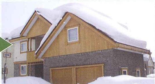
天然石ストーンチップを焼付けた表面加工の凹凸が積雪を屋根上でしっかりと止めて、勾配屋根での雪止め金具などと同等の効果を実証済みです。
